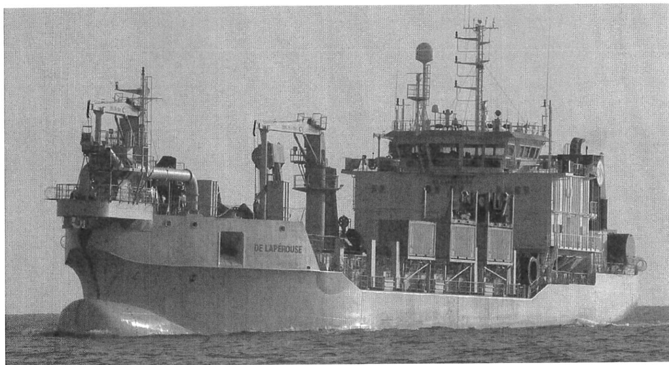
圖4 自航自載耙吸式挖泥船-迪拉號
