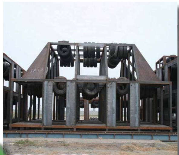
B 型大型鋼鐵礁 (10x10x5m3)
