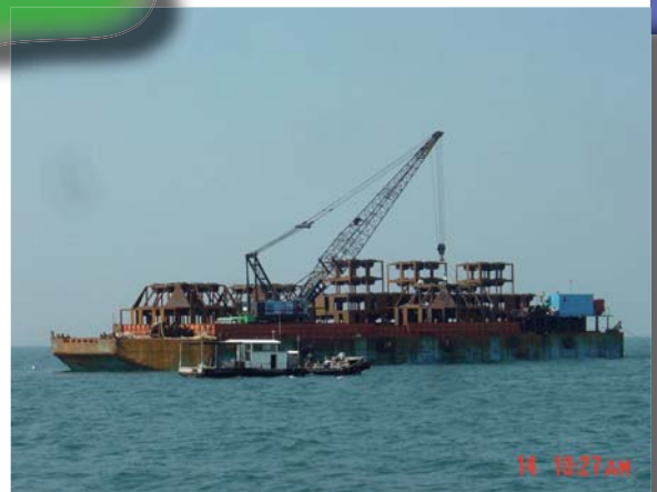
巨大的鋼鐵礁需以大型吊具搬運
