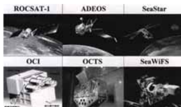
▲圖一、近十年發射並搭載有水色儀之衛星本體及感測器(臺灣之ROCSAT-1/OCT、日本之ADEOS/OCTS及美國之Seastar/SeaWiFS)。
