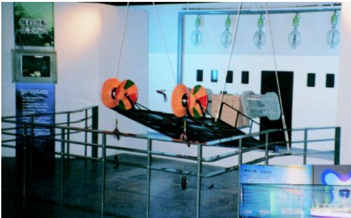
魷釣機作業模擬 魷釣機每個滾筒的釣線末端，有各間隔0.5公尺的擬餌鉤30至40個，最下端有重錘，全程作業並以電腦集中控盤操作。
