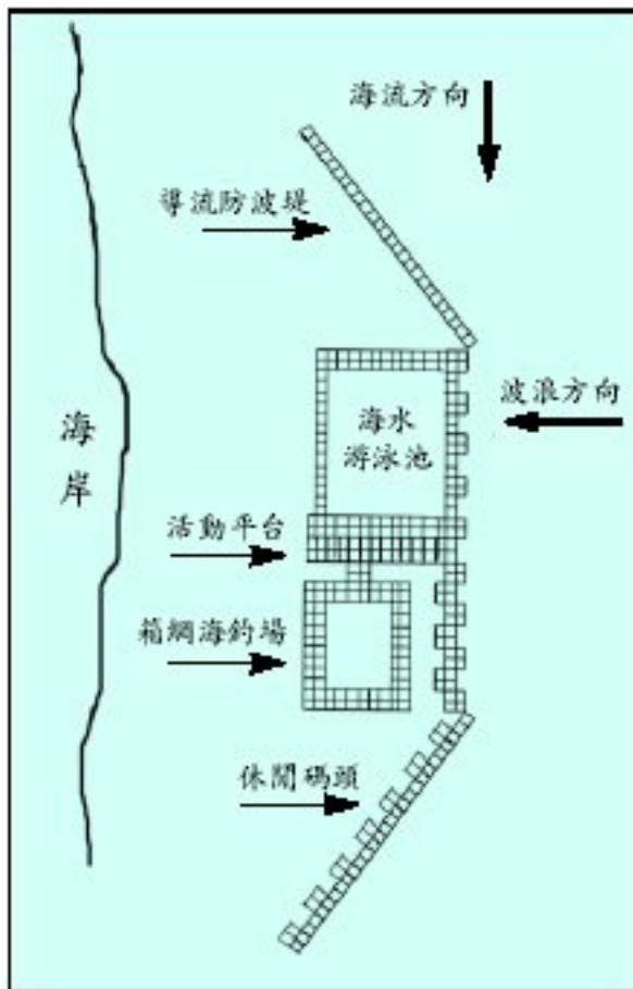
浮式導流防波堤構建海洋牧場示意圖。 (圖一)
