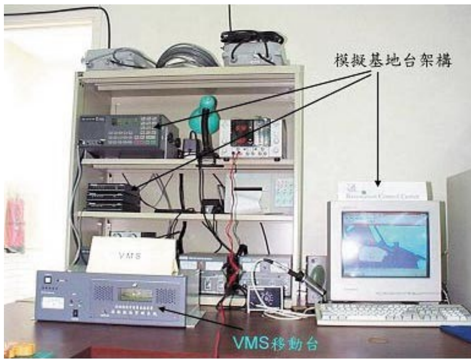
附圖九、沿近海漁船VMS系統網路測試平台（廖健銘攝）
