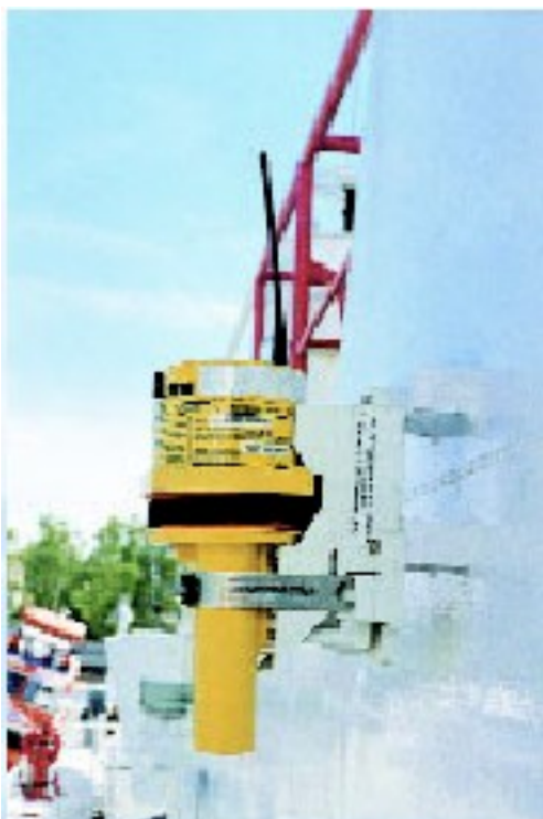
▲輔導漁船裝置EPIRB，必要時可速傳送船位。 (周清和攝)
