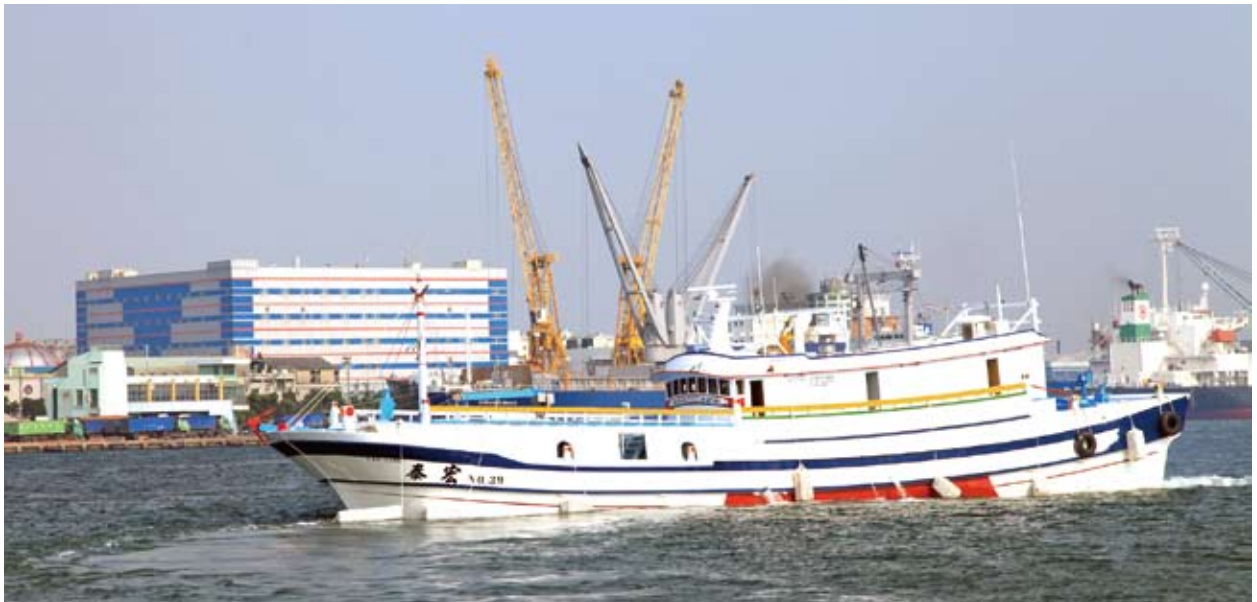
▲ 總重276噸的「泰宏39號」每航次最多可載運36公噸，比傳統運搬船多出0.5至5倍；最大船速13節，較現有運搬船快，且耗能低、效率高，有效提高運輸競爭力。
