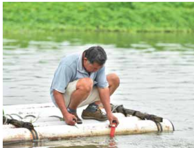
檢測水中酸鹼值與溫度。
