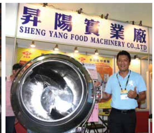
滾筒烘炒機可製作魚鬆，還可製作XO醬等製品，節省人工拌炒時間。
