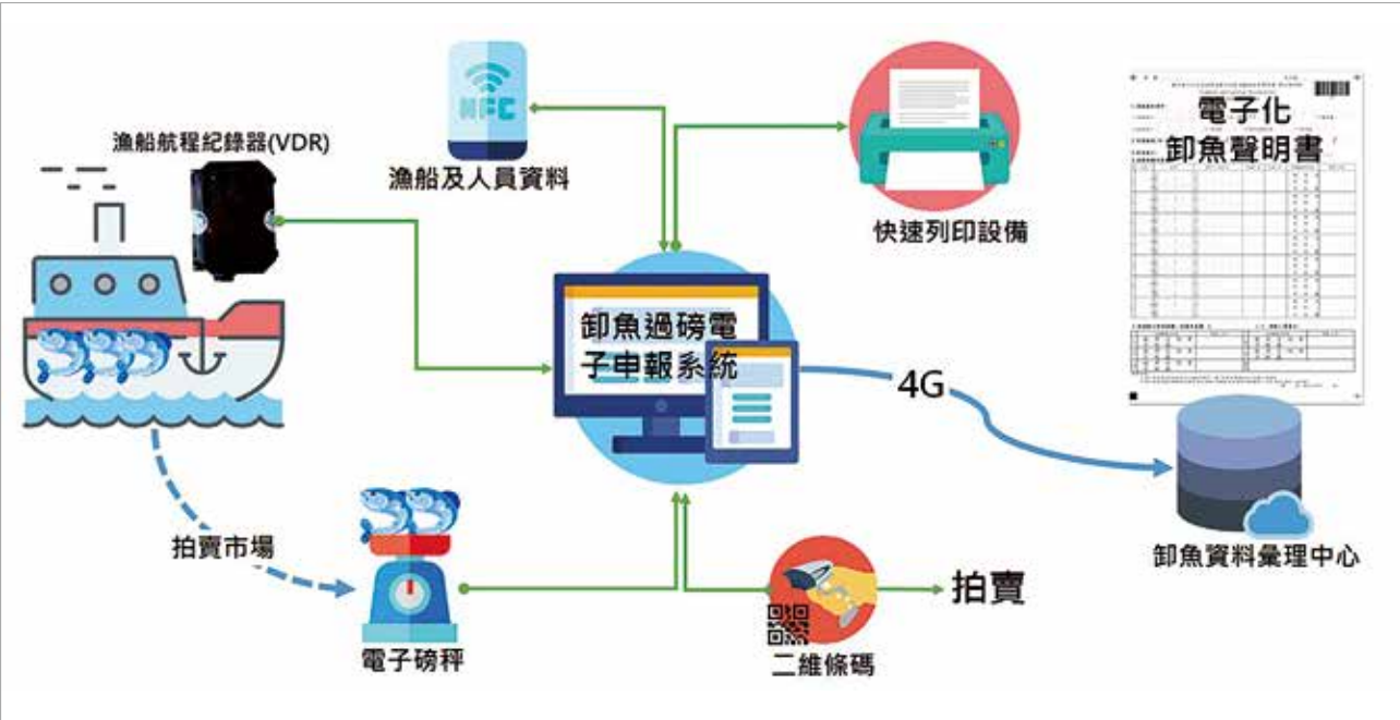
圖2、電子化磅秤系統的構想示意圖。
