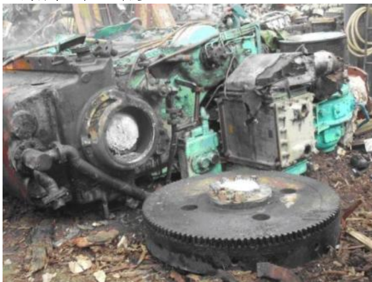
主機引擎曲軸切斷後
