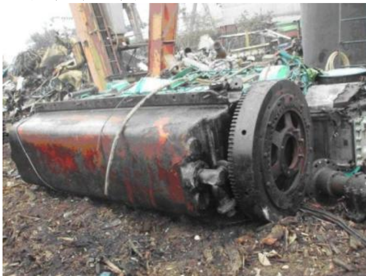
主機引擎曲軸切斷前
