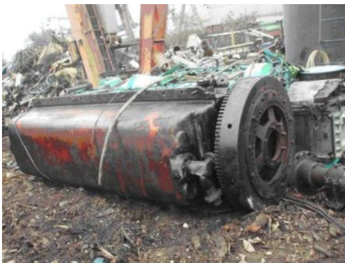
主機引擎曲軸切斷後
