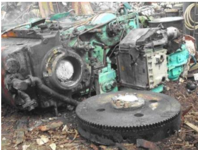
主機引擎曲軸切斷後
