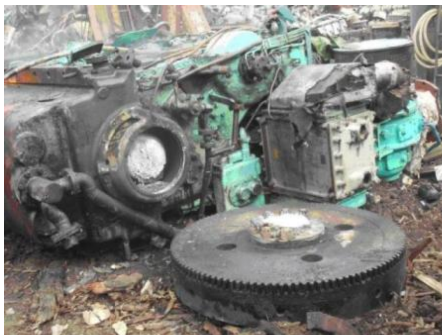
主機引擎曲軸切斷後
