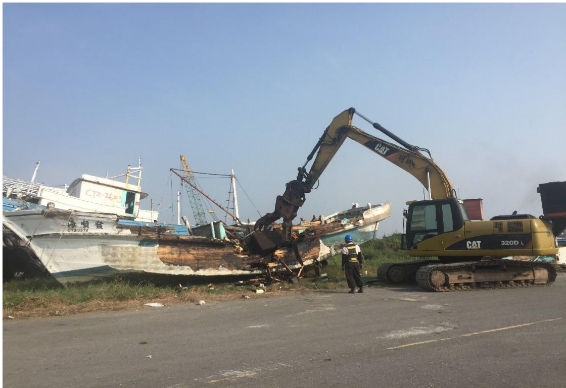
圖 8、收購漁船搗毀-收購漁船後由大型機械進行搗毀
