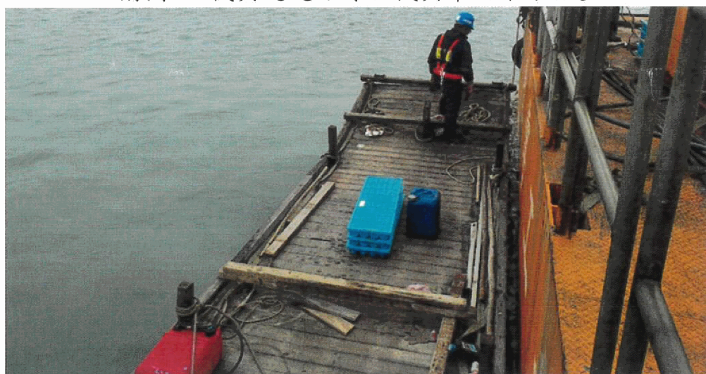
附圖三 碼頭岸側人員接駁用浮台尺寸 7.5m(長)×1.8 寬
