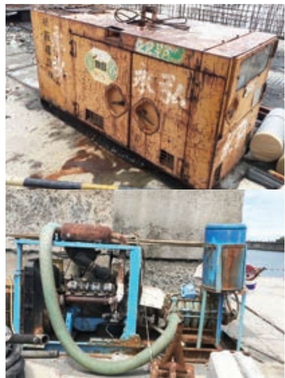
備妥發電（上）及抽水（下）設施（屏東縣東港泊區南側深水碼頭整建工程）
