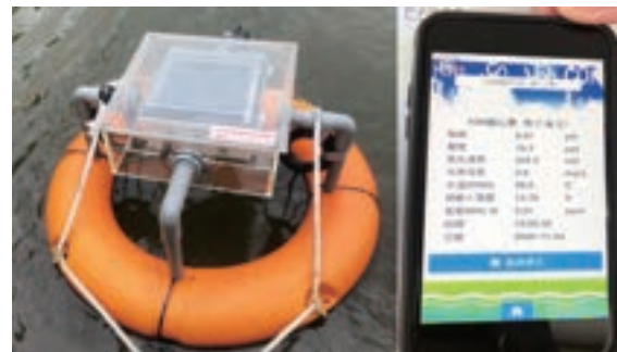
魚塭智慧水質監測系統，透過IoT即時透過雲端傳遞水質監測數據至使用者
