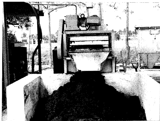
圖 1. 帶濾式污泥脫水機
