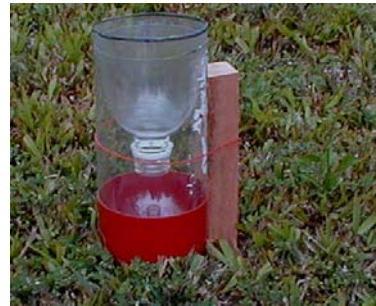
圖 5. 製作簡易雨量計之固定方式。
