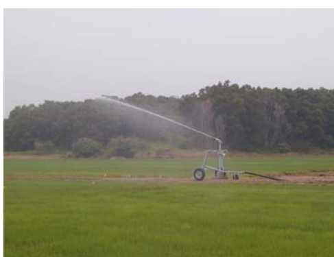
圖 2. 高壓自捲式噴灌機連接拖曳噴槍進行噴灌。
