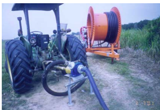
圖 1. 高壓自捲式噴灌機在曳引機之 PTO 帶動下抽水灌溉。
