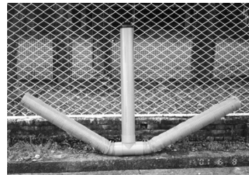
圖2. 塑膠滲漏水之收集管。
