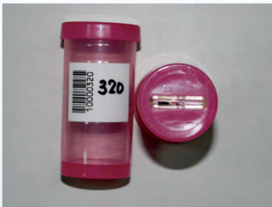
圖3. RFID晶片乳樣瓶 結合RFID晶片及辨識條碼，此2種辨識方式皆可應用於電腦資料整理。
