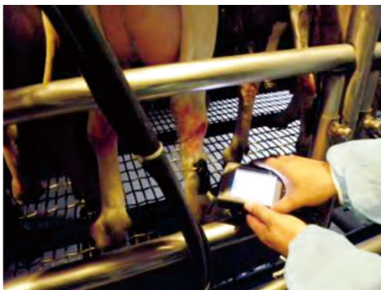
圖1. PDA及RFID晶片 操作人員手持PDA，讀取羊隻腳上之RFID晶片，有效率的辨識羊隻身分。
