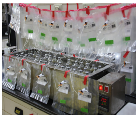
▲蝴蝶針簡易試管發酵方法裝置
