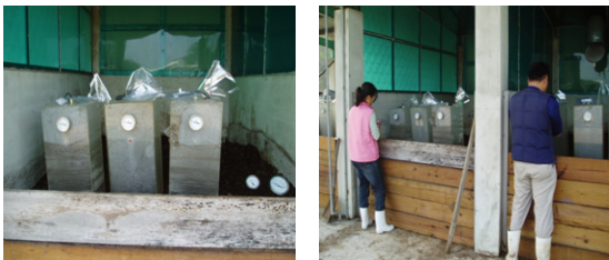
▲箱型送風式堆肥舍試驗現場與氣體採樣罩
