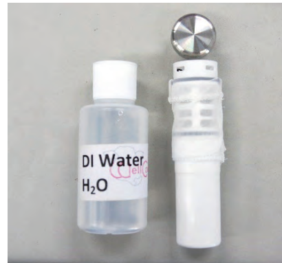
▲乳牛瘤胃溫度及酸鹼值偵測系統 (WellCow™) 之膠囊型溫度及酸鹼值感測器及校正液
