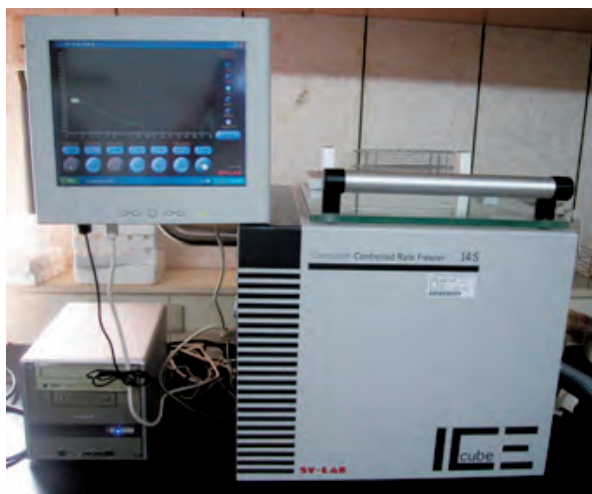
▲自動降溫儀製作豬冷凍精液
