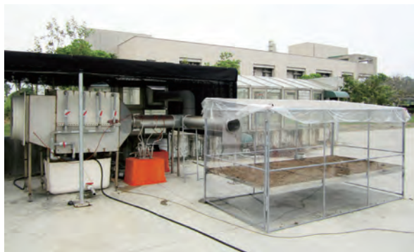
▲蛋雞糞利用太陽能乾燥房及洗滌設施去除脫水過程逸散之空氣污染物
