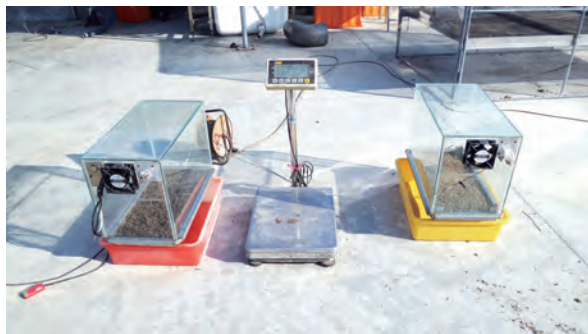
▲蛋雞糞利用小型玻璃罩脫水試驗
