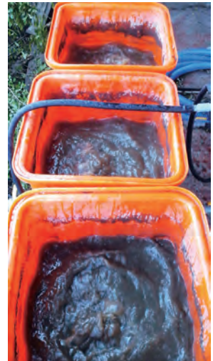
▲廢水處理模型場—小型好氣槽
