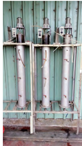
▲廢水處理模型場—小型厭氧發酵槽
