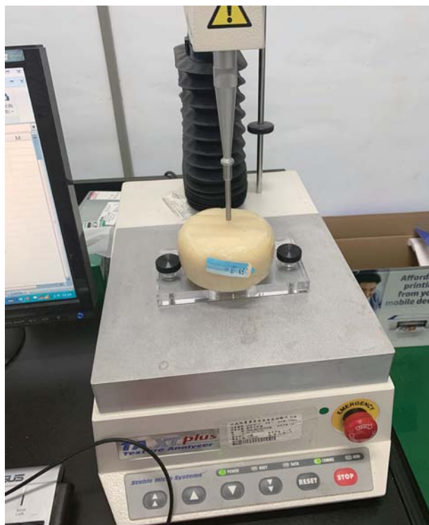
▲以物性測定儀測定羊乳高達起司之表層硬度及內部平均硬度
