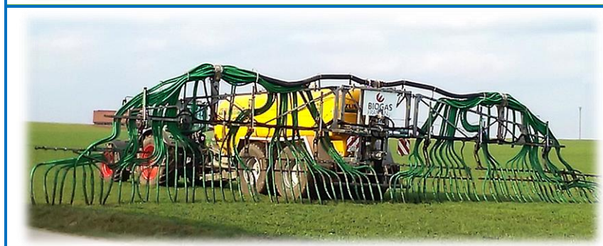
沼液沼渣施灌槽車（上圖：行駛中；下圖：進行施灌作業）
