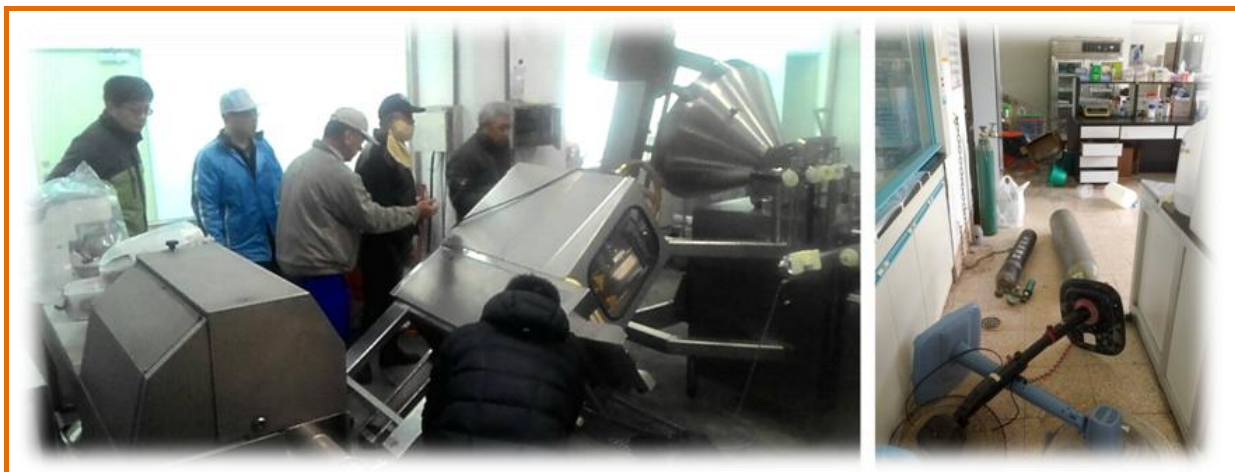
肉品工廠注射機及加工組設備因地震而倒塌或走位 / 郭卿雲 提供 105. 2. 6
